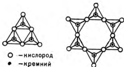
Рис. 14.17. Циклические силикат-ионы \text{Si}_3\text{O}_9^{6-} (а) и \text{Si}_6\text{O}_{18}^{12-} (б)
