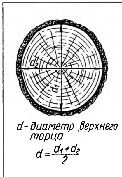
Рис. 3. Определение диаметра верхнего торца делового сортамента
