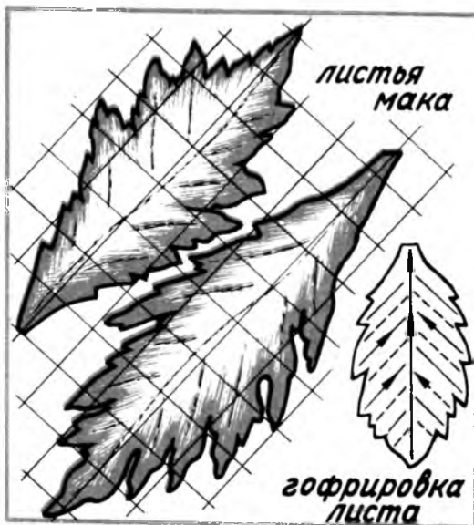
Рис. 14. Изготовление листьев мака
