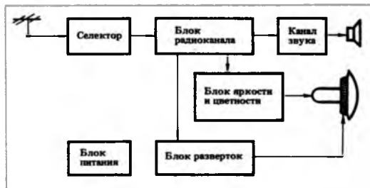
Рис. 1. Общая блок-схема цветного телевизора
