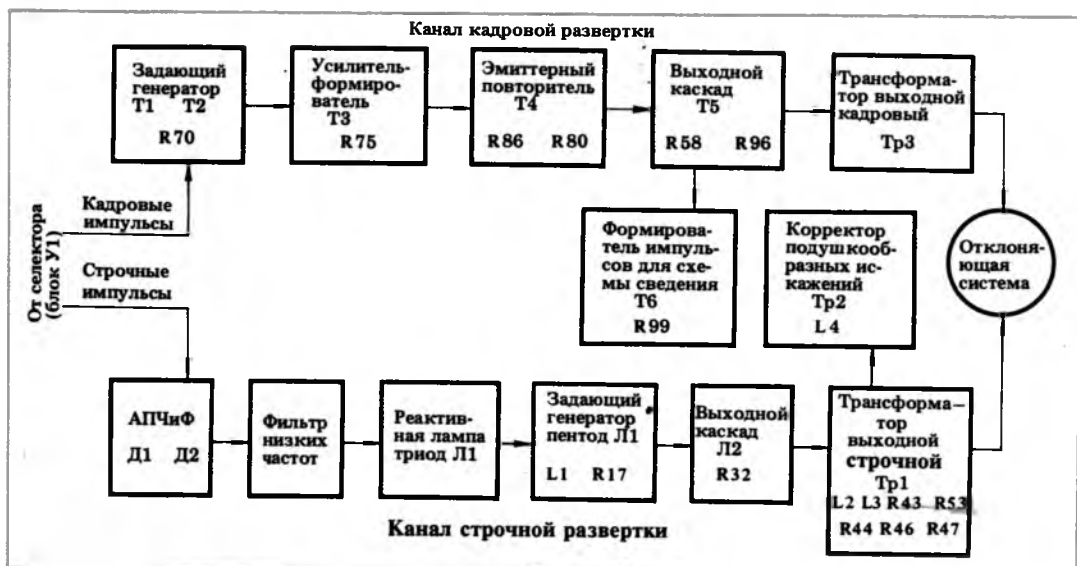
Рис. 5. Функциональная схема блока разверток
