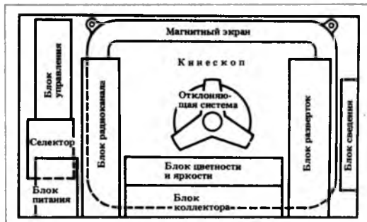
Рис. 2. Расположение всех основных телевизионных блоков
